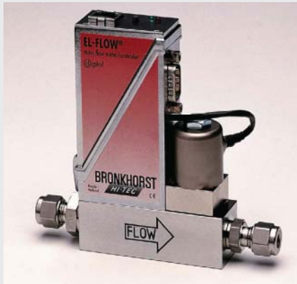
Bild 1: Massendurchflussregler bestehend aus Durchflusssensor, Regelplatine und einem magnetischen Regelventil
